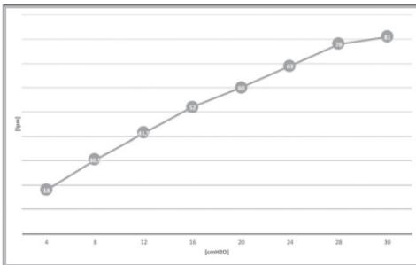
\*Datorită diferențelor de prelucrare, fluxul de ieșire din orificiile de dispersare poate varia (± 10%).
